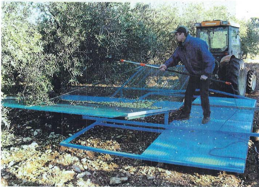
Essais du prototype d'une nacelle de récolte d'olives.
